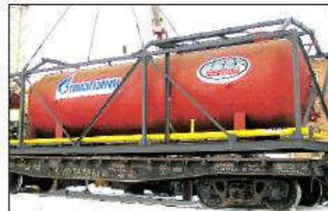
Скважинная установка сепарации выполнена в блочном исполнении, внедрена на предприятии "ТомскГазпром" и успешно эксплуатируется на газо-конденсатном месторождении в условиях его освоения.
